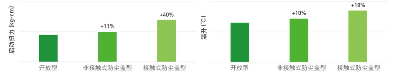
\*测试轴承: 30 BSB 62、DF排列、转速: 1800 rpm
