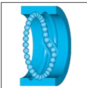
图3.5 内循环回流方式
